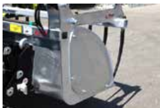
Verschraubte abnehmbare Seitenwände, angebracht für unterschiedliche Einsätze. Für verlustfreien Transport von kurzgehäckselter Silage oder breiigem Dung.
